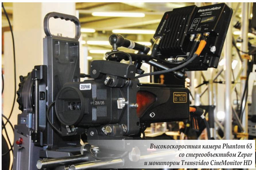
Высокоскоростная камера Phantom 65 со стереобъективом Zepar и монитором Transvideo CineMonitor HD
